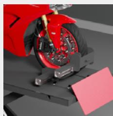
Le pont AGILA234EH est équipé d'une **pince de roue avant**, **amovible rapidement et sans outil**, pour passer rapidement d'un véhicule 2 roues à un véhicule 3 ou 4 roues ou inversement.
